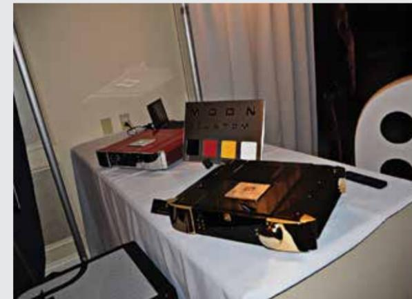
В линейке Moon Neo прибавление — ЦАП с опциональным сетевым модулем MiND. Аппарат способен декодировать материал в формате DSD вплоть до DSD 256, поток PCM с разрешением до 32 бит / 384 кГц, а также записи в формате DXD. Конвертер имеет все возможные входные интерфейсы, среди которых AES/EBU, USB, коаксиальный, оптический и даже Bluetooth с поддержкой протокола aptX.
