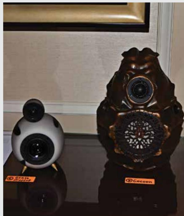
Акустические системы Sosoop от «АртЗвука» изготовлены из бронзы и имеют монолитную 18-килограммовую конструкцию, не подверженную резонансам. Выглядят колонки просто потрясающе, а ведь есть еще и ограниченная серия в корпусе из серебра. Настоящие же ценители роскоши могут заказать корпуса, покрытые чистым золотом!
