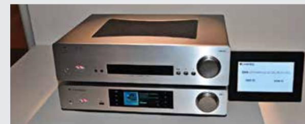
Интегрированный усилитель Cambridge CXA80 (вверху) выдает 2 x 80 Вт, построен по схеме «двойное моно» и оснащен как аналоговыми, так и цифровыми входами. Сетевой проигрыватель CNX (внизу) построен на базе Stream Magic 6 v2, имеет большой экран, поддерживает AirPlay и DSD 64 через USB.
